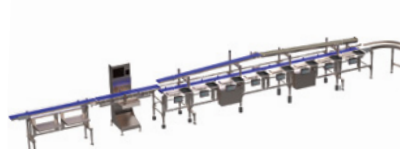
IPS small: 2 Ebenen mit Förderlinien und frontalen Wägetischen und automatische Kontrollwaage.
