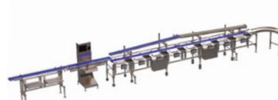
IPS small: Linea con 2 livelli e tavoli di pesatura frontali e selezionatrice ponderale automatica
