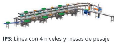
**IPS**: Línea con 4 niveles y mesas de pesaje frontales, controladora de peso automática y etiquetadora
