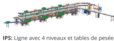
IPS : Ligne avec 4 niveaux et tables de pesée frontales, trieuse pondérale automatique et étiqueteuse.
