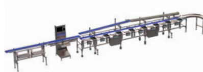
IPS small : Línea con 2 niveles y mesas de pesaje frontales y controladora de peso automática
